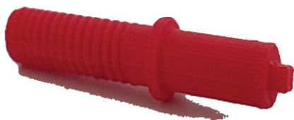
10 paveikslas. 3D spausdintuvu atspausdintas sraigtas
