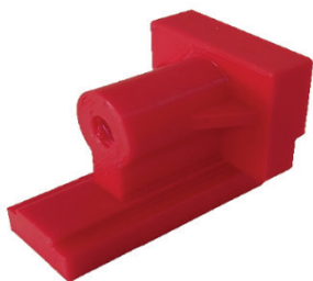
12 paveikslas. 3D spausdintuvu atspausdinta slankioji žiauna
